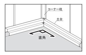
②土台の天端までコンクリートを打設してください。
